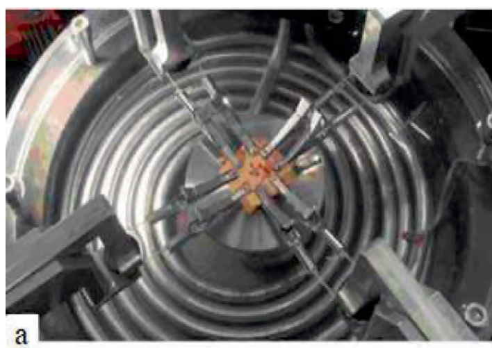
Рис. 4. Определение механических характеристик тканей стенки аорты in vitro : а) определение эластических свойств тканей; б) определение прочности стенок
